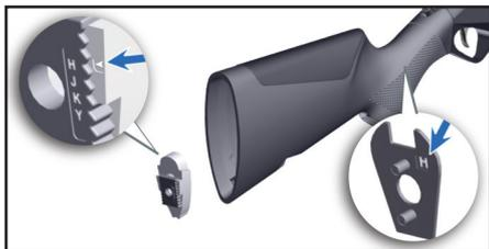
**ВНИМАНИЕ:** если прикладу придан **правый или левый отвод (DX/SX)**, фиксирующий вкладыш должен быть установлен таким образом, чтобы сторона с маркировкой была обращена в сторону затыльника.
