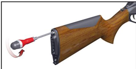
3. При помощи шестигранного (имбусового) ключа, введённого в полость приклада, вытолкнуть **резиновую**
