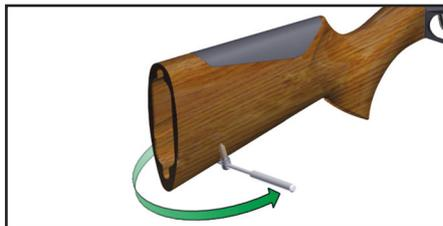
5. Установить на приклад **амортизатор**, а затем **затыльник**.
