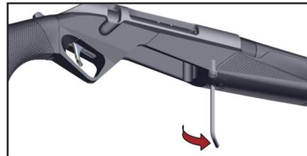
6. Отсоединить блок УСМ (a-b) от затворной коробки, отвинтив два боковых винта.
