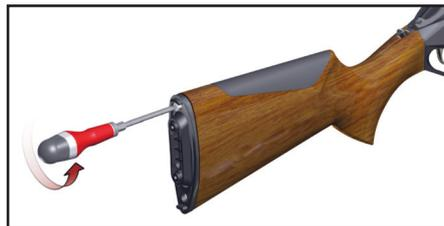
3. Ввести отвёртку в полость приклада и через отверстие в верхней его части надавить на ближайшую к вам часть гребня **(a)** до его полного высвобождения из фиксатора. Затем потянуть гребень вверх и полностью отсоединить его от приклада **(b)**.
